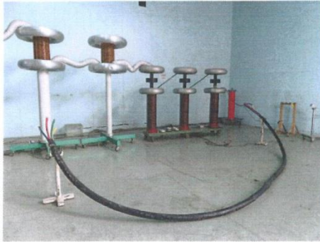
A2: 样品交流耐压试验
