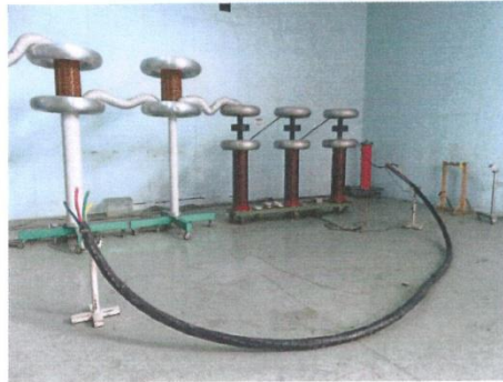
A2: 样品交流耐压试验
